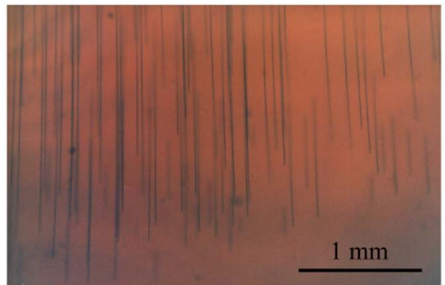
Рисунок 1.5 – Оптическая просвечивающая микроскопия тонкого среза \text{ZnGeP}_2 , разрезанного вдоль оси роста. Ось роста направлена вверх [46]
