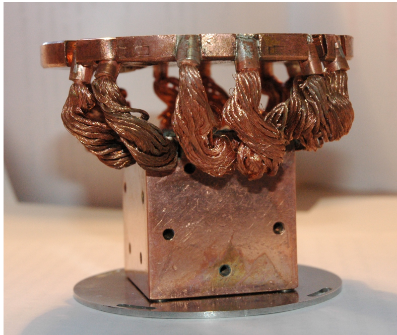
Рисунок 19. II-я модификация разрезного охладителя.
